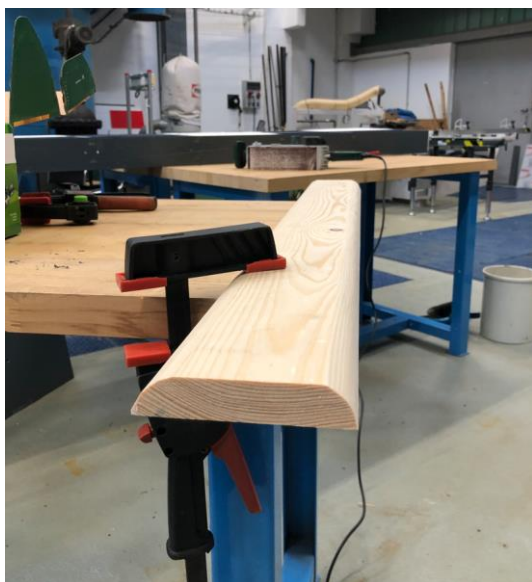
Obr. 6.1 Zaoblený dřevěný díl na horní plochu plováku.
