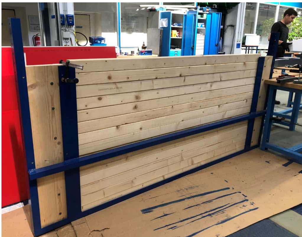
Obr. 5.1 Uzávěr z povodní strany (zcela zahrazený KVH hranoly).
