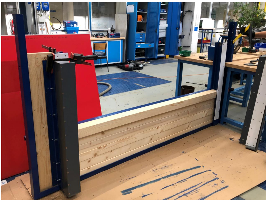
Obr. 5.2 Uzávěr z návodní strany s instalovanými drážkami pro plovák.
